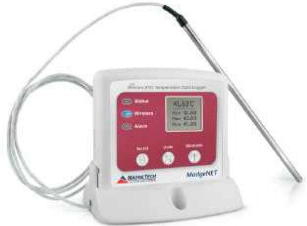
ワイヤレス温度ロガーRFRTDTemp2000A は、21,504 メモリーを有する高精度な温度データロガーです。RFRTDTemp2000A は1秒~24時間の間で指定した測定間隔で測定中の温度データをパソコンにリアルタイムで転送し、同時に本体内部メモリーに温度データを測定日時とともに保存します。
